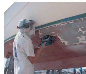
Trabajos de mantenimiento en astilleros.
